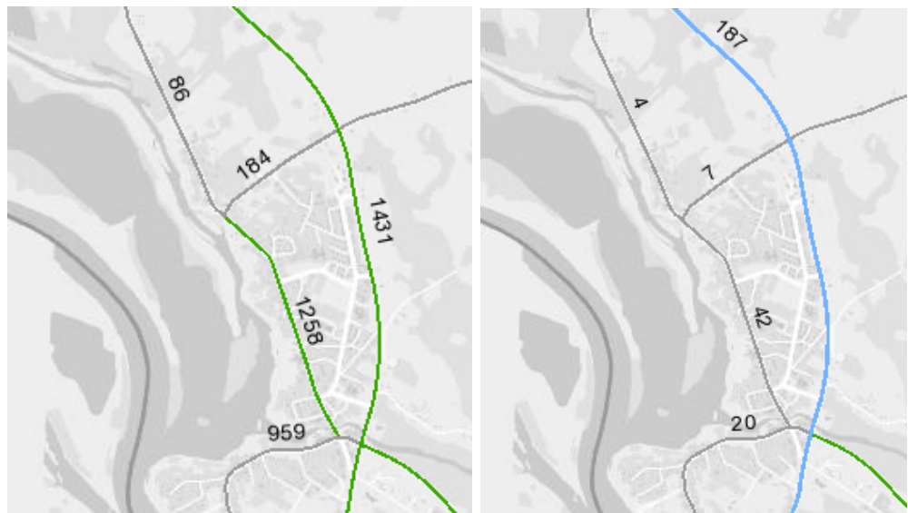
Kuva 18. Liikennemäärät Puthaanrannantiellä on 1258 ajon./vrk, josta raskaan liikenteen määrä on 42 ajon./vrk. Lähde: Liikenneviraston tieliikennemääräkartat 2014.
